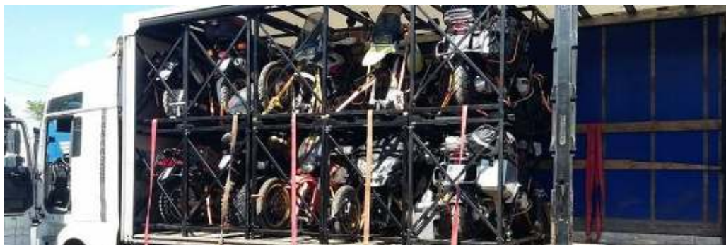
Rys. 2. Sposób umieszczenia palet transportowych wraz z motocyklami w samochodzie ciężarowym [3]
